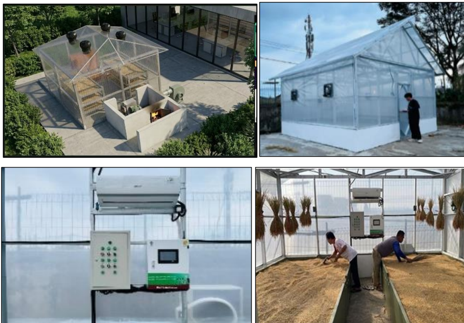
Gambar 1. Instore Dryer untuk Pengeringan dan Penyimpanan Benih Padi
