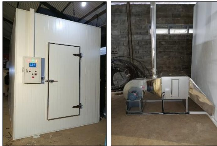
Gambar 4. prototipe In-Store Dryer untuk curing bawang putih benih dengan sistem kendali otomatis
